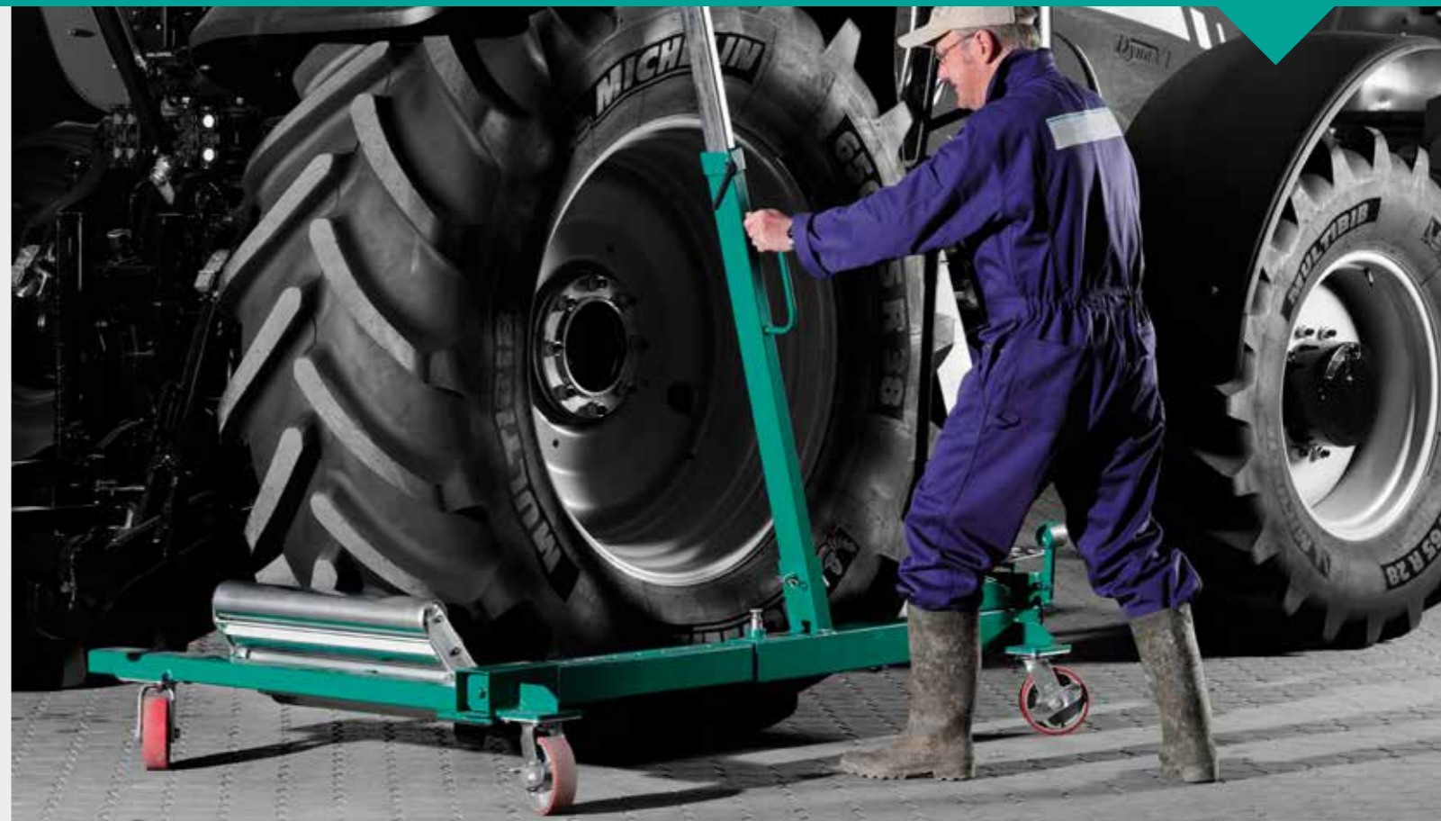
In grado di movimentare ruote da 1250 mm fino a 2400 mm di diametro e fino a 1050 mm di profondità.
